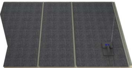
Découpe avec le rabot bleu pour créer la languette sur la partie droite
