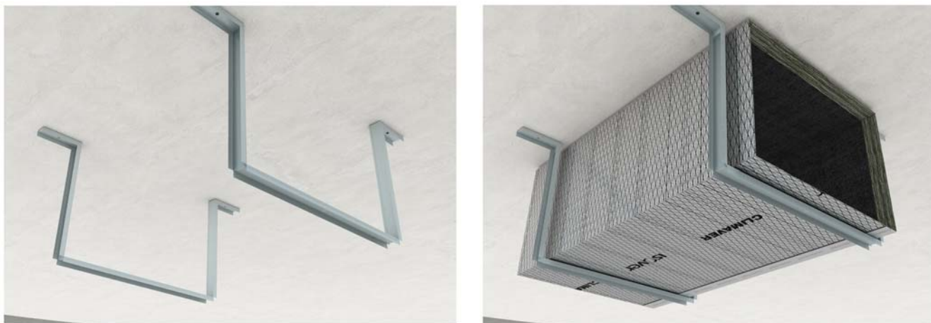
Figure 31 – Système de supportage avec un profilé type fourrure plié ou avec une bande perforée pliée
