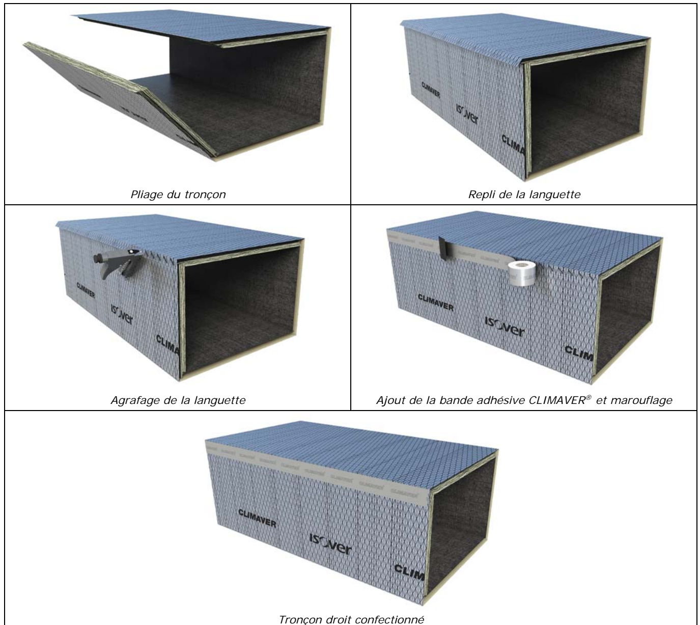
Figure 5 – Tronçon droit : fermeture
