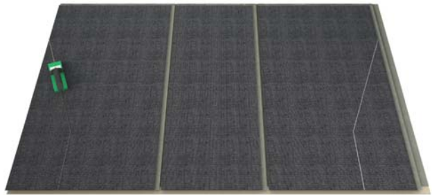
Découpe avec le rabot vert à lames droites de la partie gauche
