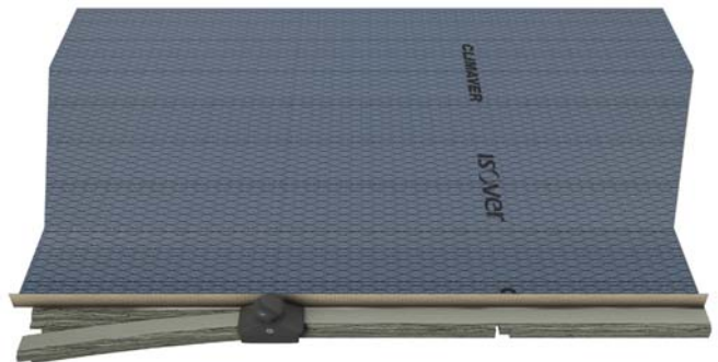
Traçage et découpe de la pièce en « U » selon les dimensions du couvercle
