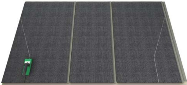
Découpe avec le rabot vert à lames droites de la partie gauche
