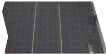
Découpe avec le rabot bleu pour créer la languette sur la partie droite
