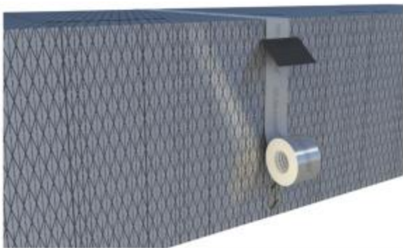
Appliquer la bande adhésive CLIMAVER® sur la jonction puis maroufler
