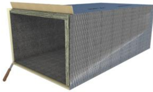
Ouverture des languettes aluminium de la feuillure mâle
