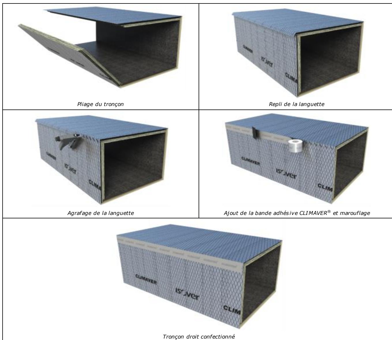
Figure 6 – Tronçon droit : fermeture
