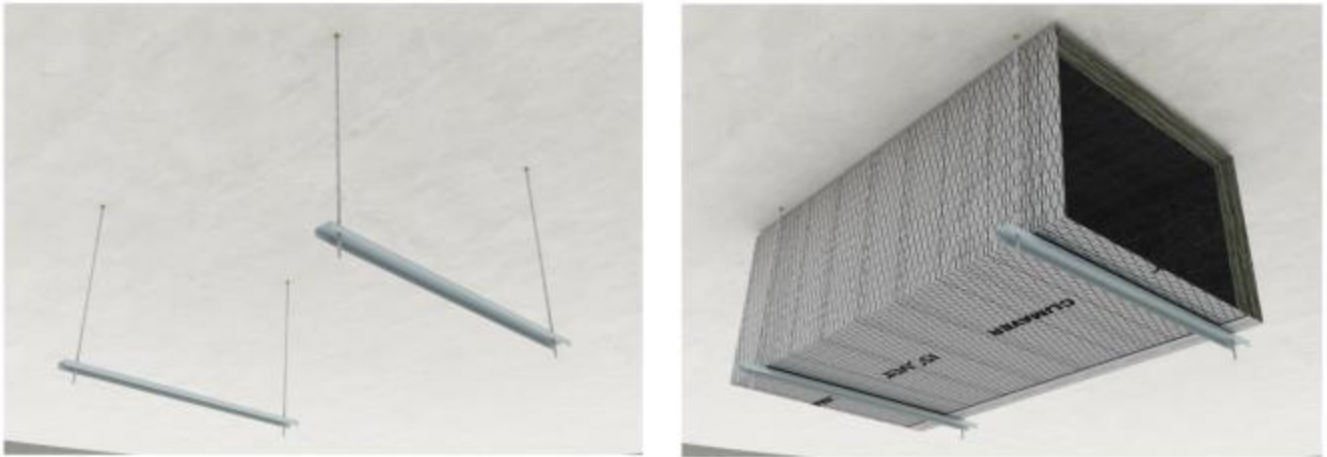
Figure 33 – Système de supportage avec un profilé et deux tiges filetées
