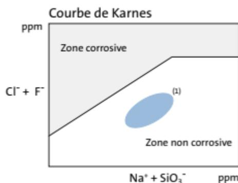
Remarque : les analyses chimiques des ions réalisées conformément aux normes ASTM C-795 et C-871 montrent que les produits en laine de roche ISOVER ne génèrent pas la corrosion de l'acier car la relation des ions  $Cl^- + F^-$  par rapport aux ions  $Na^+ + SiO_3^-$  se situe dans la partie inférieure de la Courbe de Karnes.
